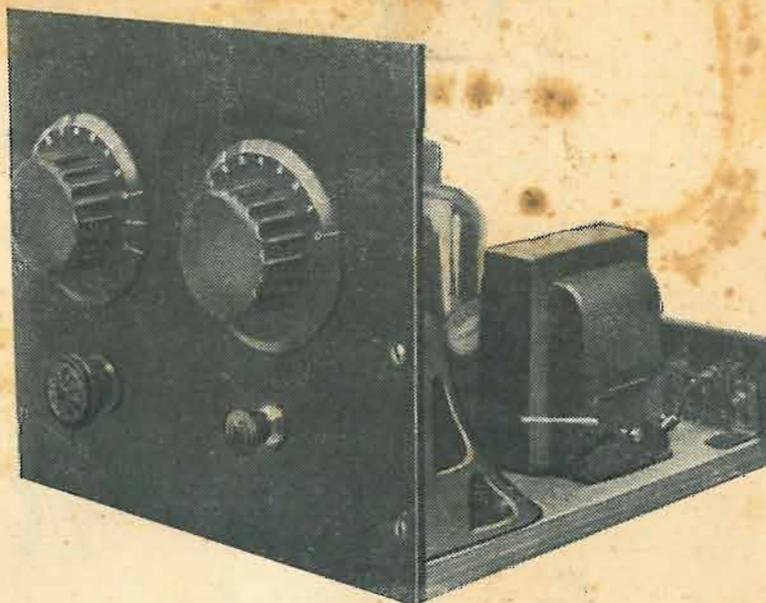
Ricevitore a due valvole allimentato dalla corrente continua.
