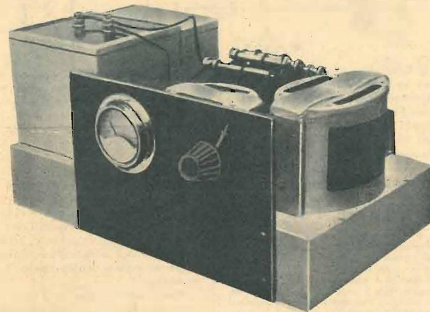
satori elettrolitici ad elevatissima capacità, onde ottenere un sufficiente filtraggio, assolutamente indispensabile per la corrente di filamento.
