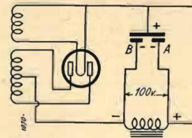
l'applicazione del condensatore al sottopannello.
