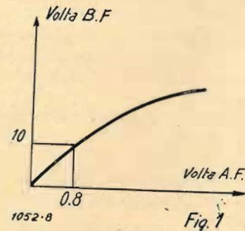
Essa è perfetta quando si tratta di tensioni deboli di alta frequenza. Il rendimento è tanto migliore quanto è più profonda la modulazione. Un'onda portante di 0,4 Volta modulata al 60% darà facilmente 10 Volta in bassa frequenza mentre che un'onda portante di 1,6 Volta modulata al 15% produrrà un sovraccarico sulla rivelatrice senza poter fornire i 10 Volta di bassa frequenza.
