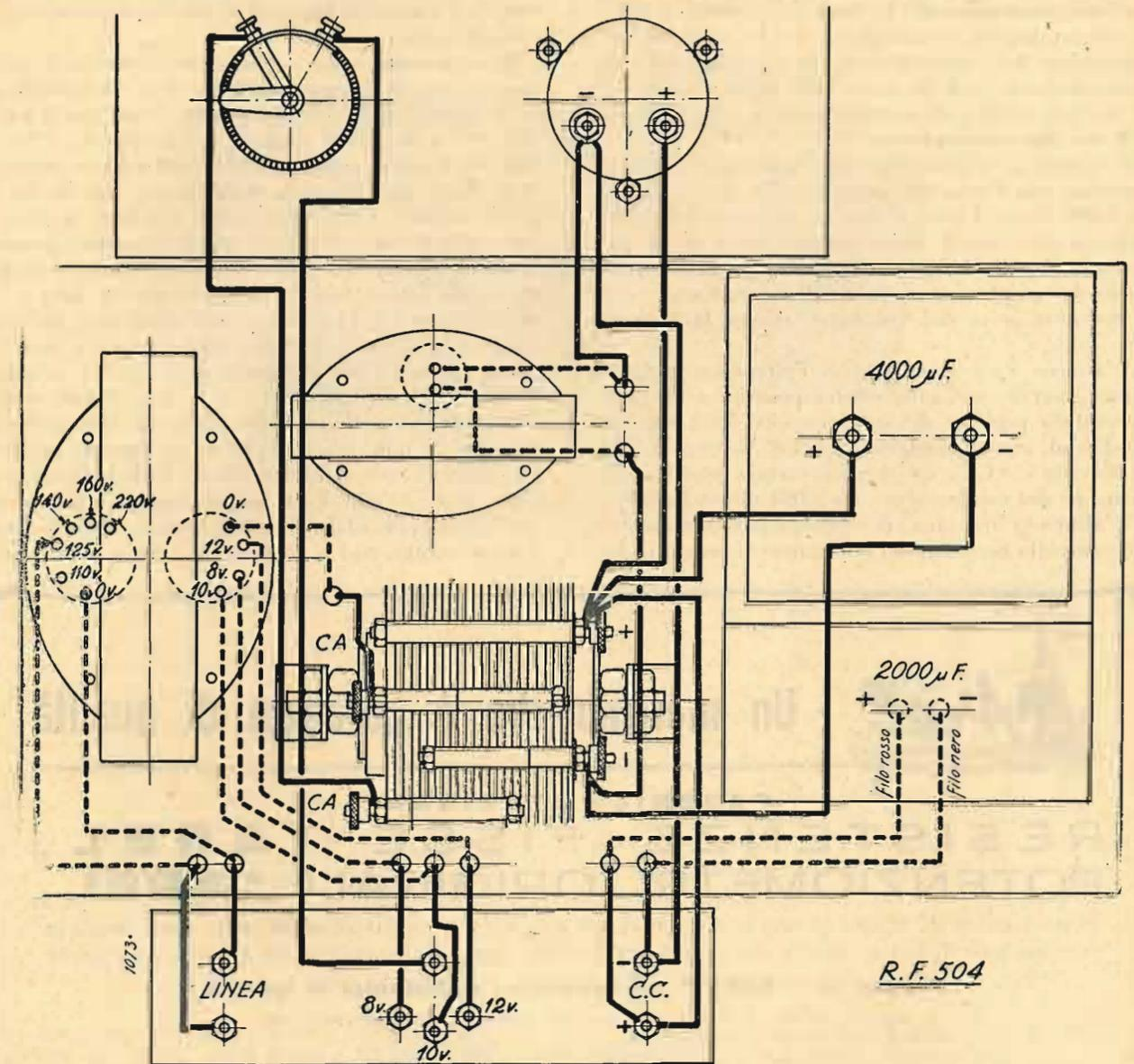
correranno ad uno chassis di alluminio avente le fiancate sufficientemente alte da potervi fissare il voltmetro. In tal modo, anche il pannellino e la striscia di bachelite non sono più necessari.
