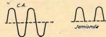
Se invece del rettificatore metallico si usa una valvola (diode), l'effetto è il medesimo, giacchè la valvola raddrizzatrice permette alla corrente di fluire soltanto in una direzione e cioè dal suo catodo (filamento) al suo anodo (placca).
