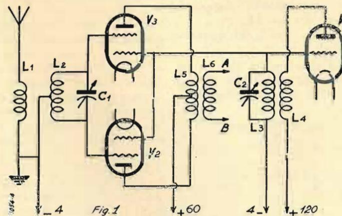
adattatore per onde corte, del tutto indipendente, alimentato dalla sorgente comune all'installazione, e che può ampliare considerevolmente la gamma del ricevitore.
